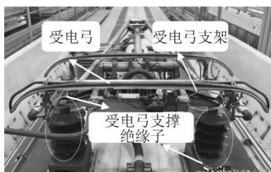
图2 CRH-380车顶支撑绝缘子实物安装图
